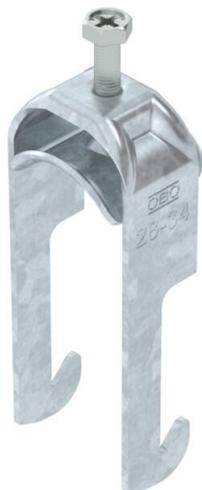
Staffa reggicavo con base a W, coppa in metallo con bordi arrotondati per proteggere il cavo. Per il montaggio verticale e orizzontale di 1 cavo singolo su profilati angolari fino a < 40 mm. Con 1 vite a pressione, testa a vite esagonale universale SW10, con fessura e taglio a croce. Per il montaggio in ambienti interni ed esterni. Si consiglia di utilizzare una controcoppa.
