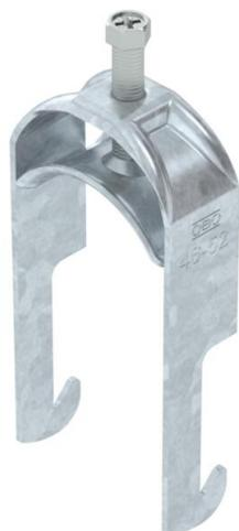
Staffa reggicavo con base a W, coppa in metallo con bordi arrotondati per proteggere il cavo. Per il montaggio verticale e orizzontale di 1 cavo singolo su profilati angolari fino a < 40 mm. Con 1 vite a pressione, testa a vite esagonale universale SW10, con fessura e taglio a croce. Per il montaggio in ambienti interni ed esterni. Si consiglia di utilizzare una controcoppa.
