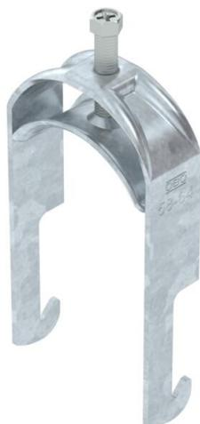
Staffa reggicavo con base a W, coppa in metallo con bordi arrotondati per proteggere il cavo. Per il montaggio verticale e orizzontale di 1 cavo singolo su profilati angolari fino a < 40 mm. Con 1 vite a pressione, testa a vite esagonale universale SW10, con fessura e taglio a croce. Per il montaggio in ambienti interni ed esterni. Si consiglia di utilizzare una controcoppa.
