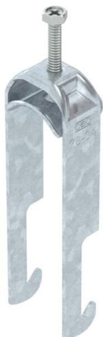
Staffa reggicavo con base a W, coppa in metallo con bordi arrotondati per proteggere il cavo. Per il montaggio verticale e orizzontale di 2 cavi singoli su profilati angolari fino a < 40 mm. Con 1 vite a pressione, testa a vite esagonale universale SW10, con fessura e taglio a croce. Per il montaggio in ambienti interni ed esterni. Si consiglia di utilizzare una controcoppa.
