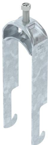
Staffa reggicavo con base a W, coppa in metallo con bordi arrotondati per proteggere il cavo. Per il montaggio verticale e orizzontale di 2 cavi singoli su profilati angolari fino a < 40 mm. Con 1 vite a pressione, testa a vite esagonale universale SW10, con fessura e taglio a croce. Per il montaggio in ambienti interni ed esterni. Si consiglia di utilizzare una controcoppa.
