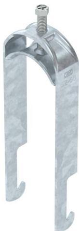
Staffa reggicavo con base a W, coppa in metallo con bordi arrotondati per proteggere il cavo. Per il montaggio verticale e orizzontale di 2 cavi singoli su profilati angolari fino a < 40 mm. Con 1 vite a pressione, testa a vite esagonale universale SW10, con fessura e taglio a croce. Per il montaggio in ambienti interni ed esterni. Si consiglia di utilizzare una controcoppa.
