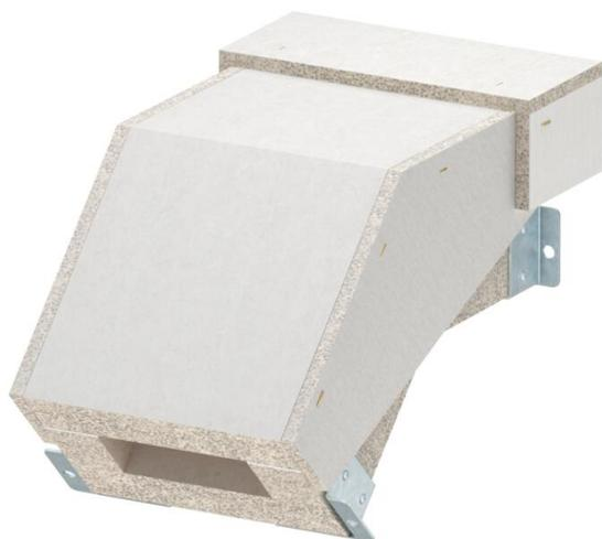
Curva verticale discendente per canale antincendio PYROLINE® Con S, tipo BSKH09-K0511 in calcestruzzo leggero con fibra di vetro resistente all'acqua e al gelo per realizzare variazioni di direzione verticali (45°) nello sviluppo del canale. I materiali di collegamento montati consentono un rapido montaggio dei pezzi del canale sul posto, i coperchi allentati consentono una rapida revisione e disposizione successiva.
