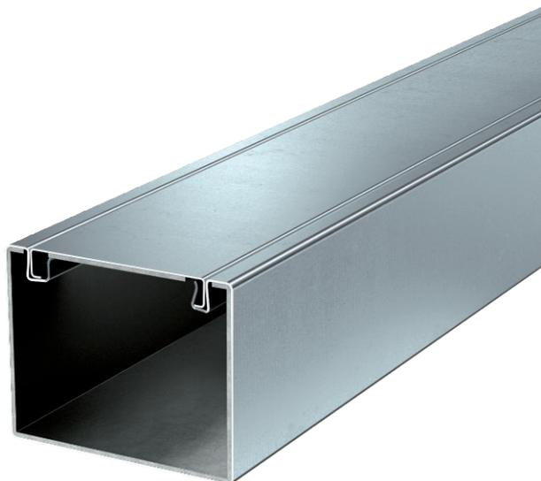
Canale in metallo con tessuto antincendio intumescente per la posa ignifuga dei cavi. Classificato come canale di installazione EI30, EI60 e EI90 a norma EN 13501-2, verificato secondo la norma EN 1366-5. Il canale impedisce la propagazione dell'incendio per l'intervallo di tempo classificato e protegge dalle conseguenze dell'incendio dei cavi.
