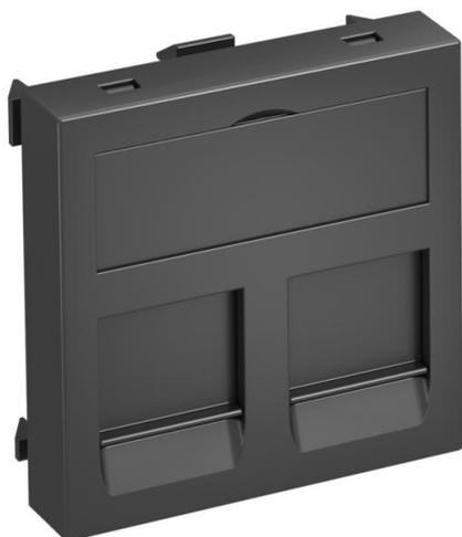
Supporto per modulo di collegamento dati con uscita dritta e chiusura per la presa di due moduli di collegamento per tecnica per dati con presa RJ45. Il fissaggio a incastro è adatto per l'incasso orizzontale e verticale dei dispositivi. Il Tipo B ha una apertura di montaggio 19,35/21,55 X 14,85 mm ed è progettato per il fissaggio diretto dei moduli di connessione dati nell'apertura di montaggio.
