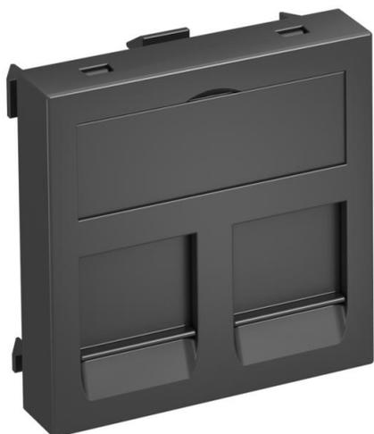
Supporto per sistemi di connessione alla linea dati. Il fissaggio a incastro è adatto per l'incasso orizzontale e verticale dei dispositivi. Il Tipo C ha una apertura di montaggio 19,30 x 14,80 mm ed è progettato per il fissaggio diretto dei moduli di connessione dati nell'apertura di montaggio.
