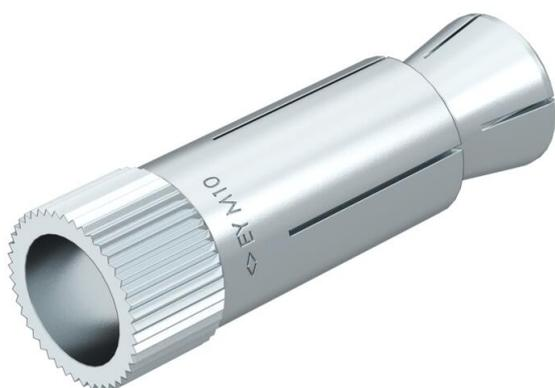
Tassello Easy per soffitti a cava di lastre di calcestruzzo precompresso. Stringendo la vite o il dado, il cono viene rilasciato dal manicotto di ancoraggio e inserito in esso. In questo modo il tassello si espande nella camera cava e crea un accoppiamento. L'ancoraggio può anche essere usato se l'area di espansione non si trova in una camera cava.
