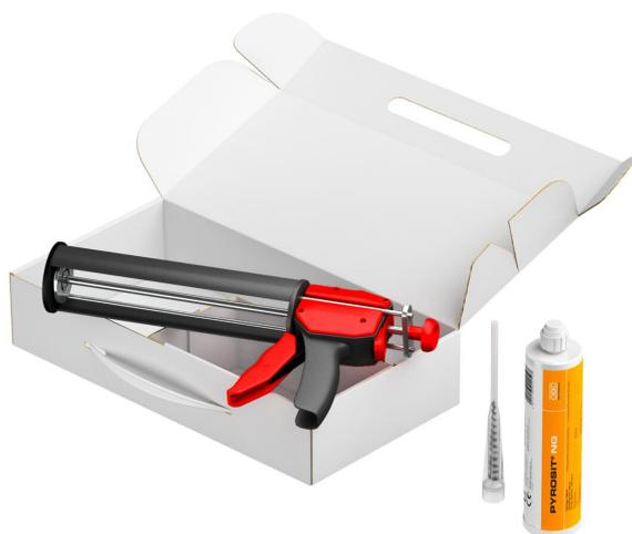
Il PYROSIT® NG Starter-Set contiene tutti i prodotti necessari per la creazione di un isolamento antincendio con bicomponente-schiuma. Il kit completo è composto da una cartuccia PYROSIT® NG, due miscelatori e da una pistola per cartucce. Adatta per cartucce coassiali 5:1. Utilizzo in ambiente interno.
