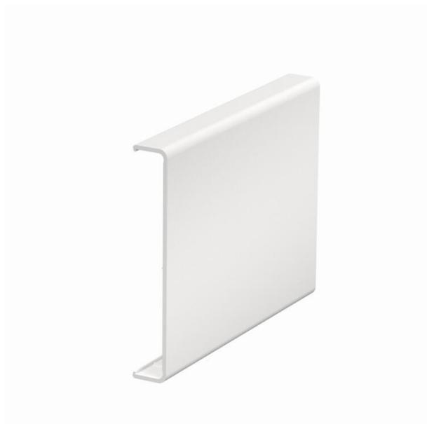
Parte superiore per la chiusura di canali per incasso apparecchi Rapid 80 GK (PVC), GS (acciaio), GA (alluminio) e colonne ISS con apertura sistema da 76,5 mm. Il contatto elettrico tra la parte superiore e quella inferiore del canale/della colonna è garantito da morsetti ad incastro del tipo RKV3V. Per ogni lunghezza di fornitura (100 mm) sono montati di serie 2 morsetti a incastro.
