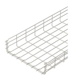
Passerella grigliata ad innesto rapido, con bordo di altezza pari a 105 mm. Per la passerella grigliata non sono necessari ulteriori componenti di collegamento in quanto vengono semplicemente agganciate l'una all'altra. La larghezza di maglia è pari a  $50 \times 100$  mm. Schermatura magnetica senza coperchio 15 dB, con coperchio 25 dB.
