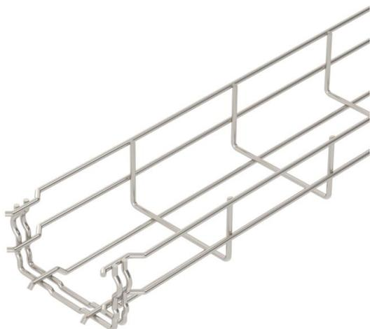
Passerella grigliata ad innesto rapido, con bordo di altezza pari a 55 mm. Per la passerella grigliata non sono necessari ulteriori componenti di collegamento in quanto vengono semplicemente agganciate l'una all'altra. La larghezza della maglia è di 50 x 100 mm (eccezione GRM 55/50 = 20 x 100 mm). Schermatura magnetica senza coperchio 15 dB, con coperchio 25 dB.
