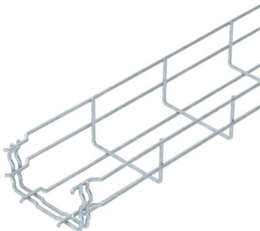
Passerella grigliata ad innesto rapido, con bordo di altezza pari a 55 mm. Per la passerella grigliata non sono necessari ulteriori componenti di collegamento, le due estremità vengono semplicemente inserite l'una nell'altra. La larghezza della maglia è di 50 x 100 mm (eccezione GRM 55/50 = 20 x 100 mm). Schermatura elettromagnetica senza coperchio 15 dB, con coperchio 25 dB.
