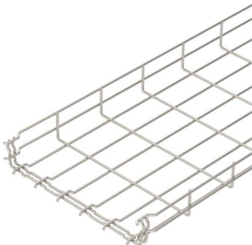
Passerella grigliata ad innesto rapido, con bordo di altezza pari a 55 mm. Per la passerella grigliata non sono necessari ulteriori componenti di collegamento in quanto vengono semplicemente agganciate l'una all'altra. La larghezza della maglia è di 50 x 100 mm (eccezione GRM 55/50 = 20 x 100 mm). Schermatura magnetica senza coperchio 15 dB, con coperchio 25 dB.
