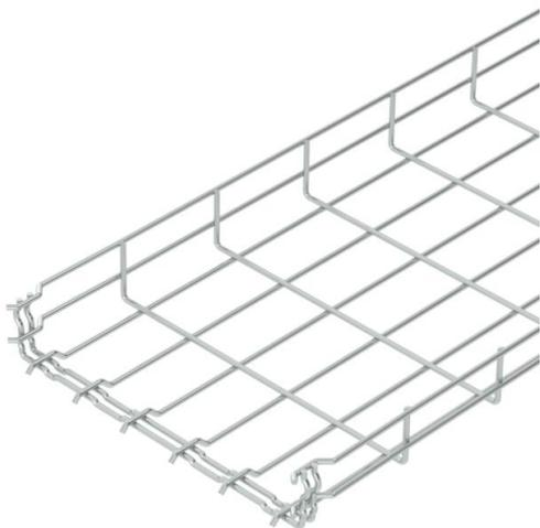
Passerella grigliata ad innesto rapido, con bordo di altezza pari a 55 mm. Per la passerella grigliata non sono necessari ulteriori componenti di collegamento, le due estremità vengono semplicemente inserite una nell'altra. La larghezza della maglia è di 50 x 100 mm (eccezione GRM 55/50 = 20 x 100 mm).
