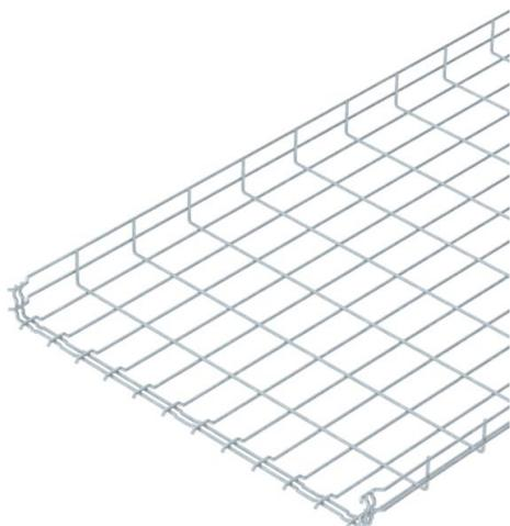
Passerella grigliata ad innesto rapido, con bordo di altezza pari a 55 mm. Per la passerella grigliata non sono necessari ulteriori componenti di collegamento, le due estremità vengono semplicemente inserite l'una nell'altra. La larghezza della maglia è di 50 x 100 mm (eccezione GRM 55/50 = 20 x 100 mm). Schermatura elettromagnetica senza coperchio 15 dB, con coperchio 25 dB.
