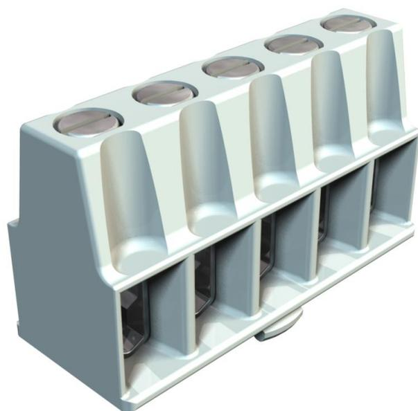
Corpo del morsetto e vite in acciaio, zincato galvanicamente e passivato trasparente, sezione nominale 1,5 ÷ 6 mm<sup>2</sup>, tensione nominale 400 V, a 5 poli, con morsetti prese, numero massimo di sezioni collegabili per morsetto: 3 x 6 mm<sup>2</sup>, 4 x 4 mm<sup>2</sup> o 6 x 2,5 mm<sup>2</sup>.
