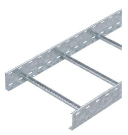
Passerella a traversini con longherone forato, con bordo di altezza pari a 110 mm, pioli del profilato a C rivettati e aperti verso l'alto. La passerella a traversini viene fornita in versione ripiegata.
