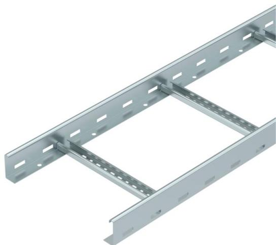
Passerella a traversini con longherone forato, con bordo di altezza pari a 60 mm, pioli del profilato a C rivettati e aperti verso l'alto (versione VS).
