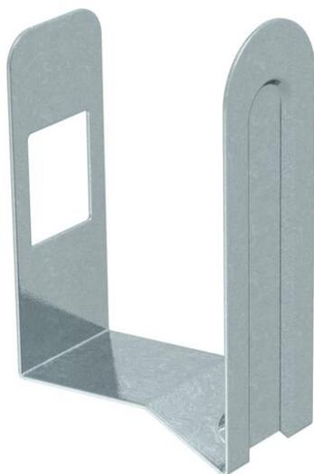
Il morsetto di fissaggio ferma il cavo inserito e le linee nel canale, facilitando così l'installazione a parete e a soffitto. Questi morsetti vengono fissati tramite foro passante ed agganciati alla parete laterale. Idoneo a larghezza canale di 100 mm.
