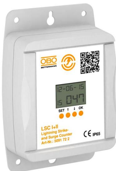
Il dispositivo LSC I+II rileva le correnti di impulsi e le salva con ora e data. In questo modo è possibile effettuare un controllo continuo se un fulmine ha colpito l'impianto parafulmini. Se ciò dovesse accadere l'impianto parafulmini deve essere sottoposto a revisione conformemente a VDE 0185-305 (IEC 62305).
