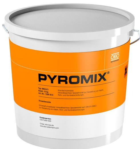
Malta antincendio per la realizzazione di isolamenti cavi combinati in pareti e soffitti. Idonea a pompe, dispositivi a pressione all'applicazione manuale. 10 kg di malta secca, con l'aggiunta di ca. 3 litri di acqua, rendono circa 10 litri di massa pronta per la lavorazione. Utilizzo in ambiente interno.
