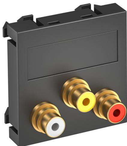
Supporto multimediale con tre prese Cinch di collegamento per l'audio / video, uscita cavo diritta, con campo di siglatura, tre innesti Cinch (RCA) nella versione presa-presa, codifica dei colori giallo / rosso / bianco. Supporto piastra con blocco di fissaggio, adatto per l'installazione orizzontale e verticale nell'ambiente di sistema.
