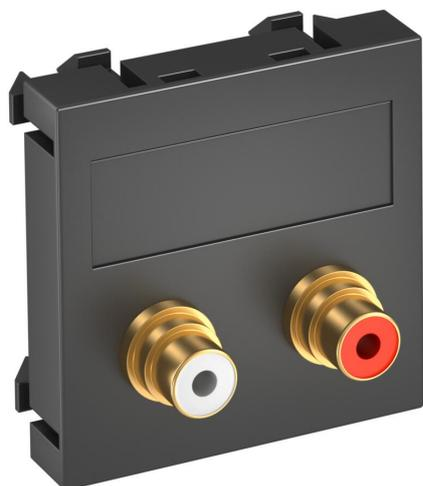
Supporto multimediale con due prese di collegamento per l'audio D/S, uscita cavo diritta, con campo di siglatura, due innesti Cinch (RCA) nella versione presa-presa, codifica dei colori giallo / rosso / bianco. Supporto piastra con blocco di fissaggio, adatto per l'installazione orizzontale e verticale nell'ambiente di sistema.
