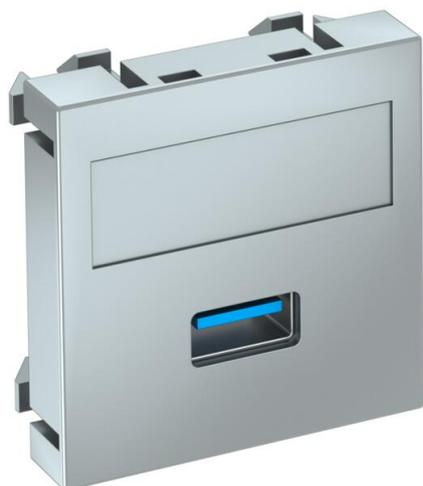
Supporto multimediale con una porta USB 3.0 , uscita cavo diritta, con campo di siglatura, presa USB 3.0, tipo A con attacco a vite. Supporto piastra con blocco di fissaggio, adatto per l'installazione orizzontale e verticale nell'ambiente di sistema.
