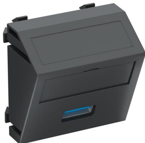
Supporto multimediale con una porta USB 3.0 , uscita cavo inclinata, campo di siglatura, presa USB 3.0 tipo A con attacco a vite. Supporto piastra con blocco di fissaggio, adatto per l'installazione orizzontale e verticale nell'ambiente di sistema.
