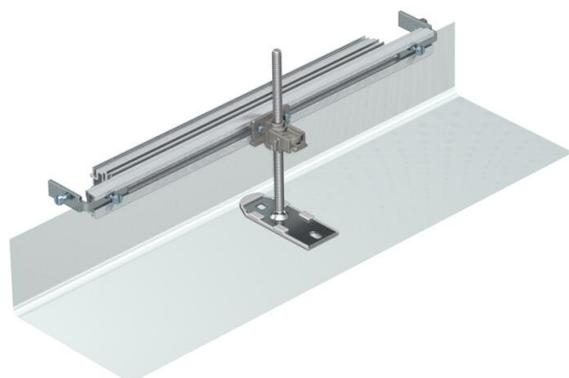
Chiusura terminale del canale pronta per il montaggio, costituita da un bordo esterno flessibile con profili laterali e di posa del rivestimento pavimento. Nella dotazione di serie sono compresi angolari di collegamento al canale e un angolare di fissaggio livellabile in altezza.
