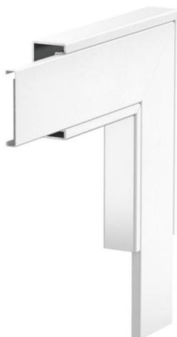
Curva piana con tessuto antincendio intumescente per canale PYROLINE® Rapid PLM. Idonea per il montaggio diretto a parete e a soffitto, nei sistemi sottopavimento o sopraelevato. Montaggio dei giunti senza attrezzi con il connettore PLM SI. Il coperchio viene fissato ad incastro senza attrezzi e consente un'ispezione rapida ed un'implementazione successiva. La sporgenza del coperchio consente di montare quest'ultimo in modo sfalsato per l'equipotenzializzazione lungo l'intero tratto del canale.
