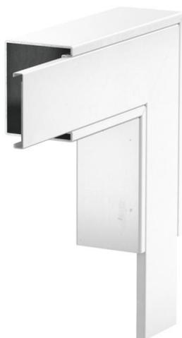
Curva piana con tessuto antincendio intumescente per canale PYROLINE® Rapid PLM. Idonea per il montaggio diretto a parete e a soffitto, nei sistemi sottopavimento o sopraelevato. Montaggio dei giunti senza attrezzi con il connettore PLM SI. Il coperchio viene fissato ad incastro senza attrezzi e consente un'ispezione rapida ed un'implementazione successiva. La sporgenza del coperchio consente di montare quest'ultimo in modo sfalsato per l'equipotenzializzazione lungo l'intero tratto del canale.
