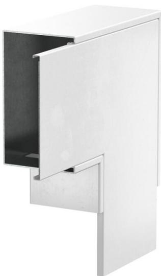
Curva piana con tessuto antincendio intumescente per canale PYROLINE® Rapid PLM. Idonea per il montaggio diretto a parete e a soffitto, nei sistemi sottopavimento o sopraelevato. Montaggio dei giunti senza attrezzi con il connettore PLM SI. Il coperchio viene fissato ad incastro senza attrezzi e consente un'ispezione rapida ed un'implementazione successiva. La sporgenza del coperchio consente di montare quest'ultimo in modo sfalsato per l'equipotenzializzazione lungo l'intero tratto del canale.
