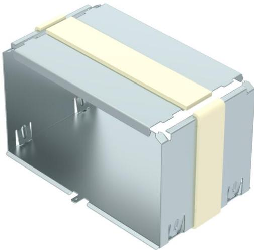
Set del giunto di connessione composto da connettore per parte inferiore del canale e supporto del coperchio. Con guarnizione integrata per la giunzione senza attrezzi del canale PYROLINE® Rapid PLM e degli accessori. Consente un collegamento costante del conduttore di protezione.
