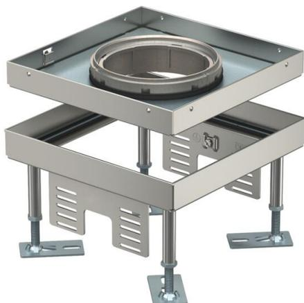
Cassetta livellabile quadrata, dimensione nominale 4, con tubo telescopico per uscita cavi adatta per pavimenti trattati a lavaggio secco o umido. Possibilità di installazione di dispositivi elettrici:
