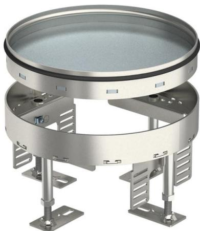
Cassetta telaio per carichi pesanti livellabile come cassetta cieca con una classe di carico 2-20 kN, 2 vie. È possibile installare 2 supporti APMT2. Per il montaggio di 2 supporti universali UT3 per 4 apparecchi di installazione singoli con anello/staffa di supporto o 6 apparecchi Modul 45 in ambienti interni.
