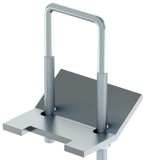
Elemento di fissaggio alle putrelle in acciaio. Il fissaggio è bidirezionale. La lunghezza dei profilati dovrebbe corrispondere almeno alla larghezza del supporto in acciaio: + 2 x 50 mm.
