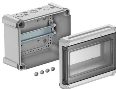
Distributore piccolo per montaggio a parete, per sottoquadro distribuzione corrente in ambienti interni e ambienti esterni protetti, secondo IEC 439-3. Con profilato di sospensione premontato 35 mm. Tipo di protezione IP66 e grado di protezione IK07. Coperchio trasparente avvitabile, con intaglio
