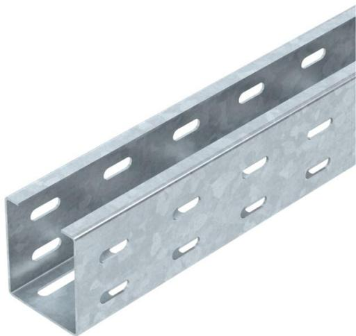
SKS 60 = sistema di passerelle portacavi pesanti con altezza laterale di 60 mm. Canalina con perforazione a pavimento e laterale passante e foro centrale (Ø11 mm) nel pavimento per fissaggi supplementari. Coperchio con bussole adatto: tipo AZDMD 50. Senza materiale di fissaggio.
