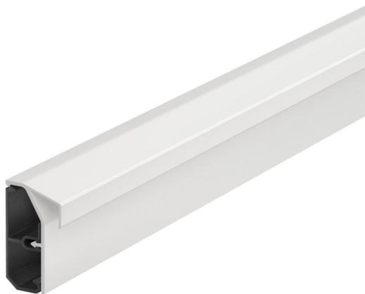
Canale a battiscopa SL-T per il passaggio del cavo coperto in ambienti interni. Il colore della parte inferiore canale può variare in base alla preparazione. Con parte superiore e inferiore a scatto con base forata per montaggio diretto a parete. Eseguire la modifica di direzione con taglio obliquo e chiudere le estremità del canale con elementi terminali. Serbatoio per apparecchi per l'assemblaggio di alimentazione di corrente e dati. Con striscia moquette per una finitura pulita.
