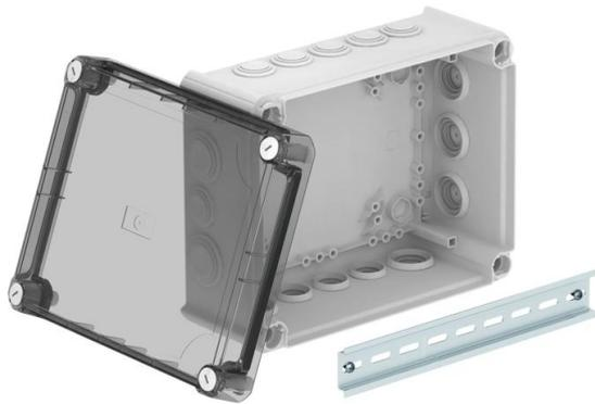
Scatola di derivazione per il collegamento di cavi e linee in ambienti interni e ambienti esterni protetti. Forma rettangolare con passacavi sui lati e inserti nel fondo. Adatta per il montaggio su pareti e soffitti, il montaggio su piastre di montaggio e a pavimento. Con la possibilità di fissaggio interno e montaggio tramite cupole angolari. Coperchio alto e trasparente con chiusura rapida, piombabile. Costruito con materiali privi di alogeni e resistenti ai raggi UV. Con guida profilata DIN.
