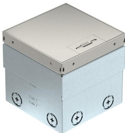
Torretta a scomparsa quadrata per l'installazione in pavimenti flottanti ed in massetto trattati con lavaggio a secco in ambienti interni. Alloggiamento da incasso con aperture preforate per tubi (M20/M25). Elemento superiore regolabile sul bordo superiore del rivestimento grazie a 4 supporti di livellamento. La profondità minima di installazione è di 100 mm, l'area di livellamento + 35 mm.
