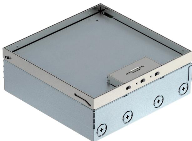
Torretta a scomparsa quadrata per l'installazione in pavimento cavo ed in massetto trattati con lavaggio a secco in ambienti interni. Alloggiamento da incasso con aperture passacavo preforate per tubi (M25). Parte superiore regolabile al bordo superiore del rivestimento grazie a 4 supporti di livellamento integrati. La profondità minima di installazione è di 95 mm, il range di livellamento di + 30 mm.
