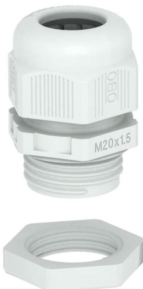
Pressacavo con filettatura metrica, adatto per scatole di derivazione, per applicazioni residenziali ed industriali. Con scarico della trazione e guarnizione di tenuta integrata, testato secondo norma CEI EN 62444. Grado di protezione IP68. Range temperatura -20°C a +65°C. Controdamo incluso.
