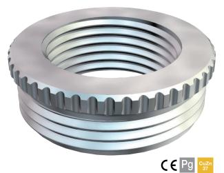
Riduzione (Parte H) secondo DIN 46320, con filettatura PG secondo DIN 40430, per il passaggio da un foro filettato PG ad un pressacavo di dimensioni inferiori.
