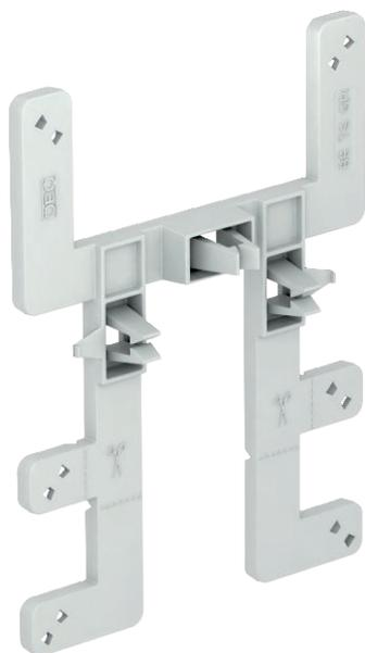
Con l'elemento di fissaggio BE TS GR, le scatole di derivazione OBO tipo T60 e T100 possono essere attaccate facilmente e rapidamente ai vassoi a rete senza attrezzi. La scatola di derivazione del cavo è tenuta saldamente in posizione. Tuttavia, può essere smontato rapidamente se necessario.
