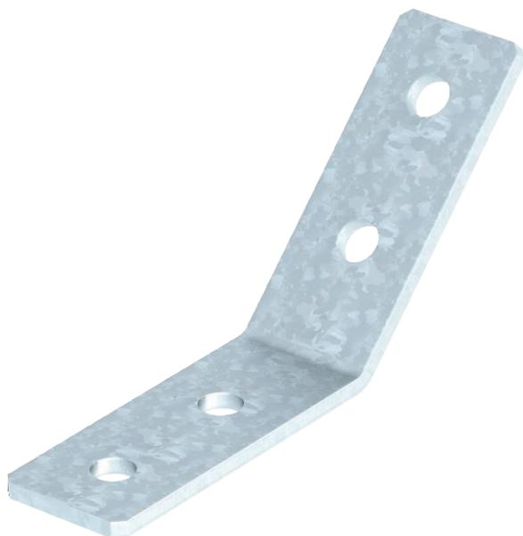
Angolare di montaggio con 4 fori per il collegamento di profilati 41 x 41 mm e 41 x 21 mm con angolo di 45°.
