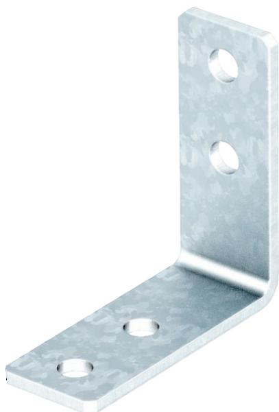
Angolare di montaggio con 2 fori per il collegamento di profilati 41 x 41 mm e 41 x 21 mm con angolo di 90°.
