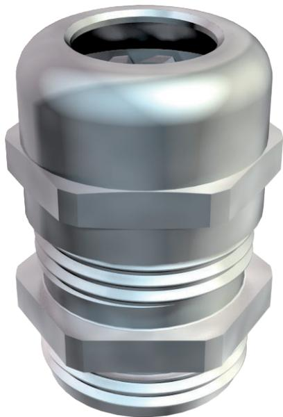
Modello di pressacavo con dado esagonale cieco a forte tenuta, oltre a scarico di trazione e protezione antitorsione a tenuta elevata, con filettatura Pg secondo DIN 40430. Inserto di fissaggio in poliammide, anello di tenuta in gomma cloroprene/nitrile, con O-ring premontato sulla filettatura di collegamento.
