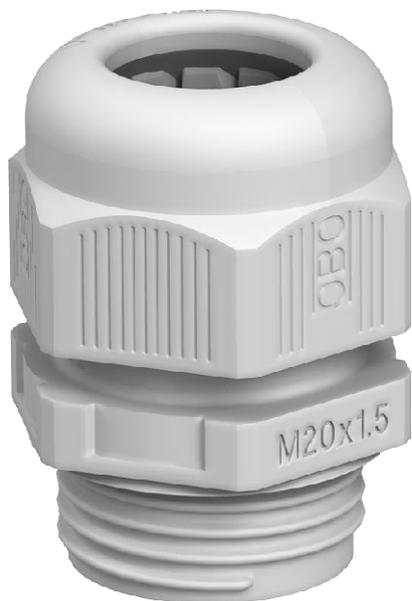
Il modo più rapido e agevole per installare pressacavi su scatole di derivazione cavi e alloggiamenti per dispositivi antistrappo e guarnizioni: i pressacavi V-TEC VM con efficacia collaudata di OBO. Grazie alle alette di tenuta e alla speciale tecnica a lamelle di OBO i prodotti sono conformi alla classe di protezione IP68. Le prove di tenuta e trazione sono effettuate secondo la norma DIN EN 62444
